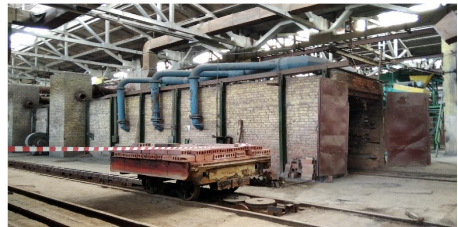
3 туннельных обжиговых печи 100 м
